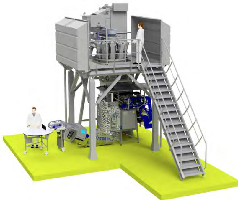
Abbildung 10. Beispiel einer vertikalen Verpackungslinie.
